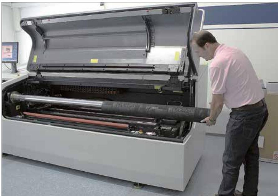
**Werner Rost, Betriebsleiter, entnimmt am Kodak Flexcel Direct System einen gravierten Sleeve.**
