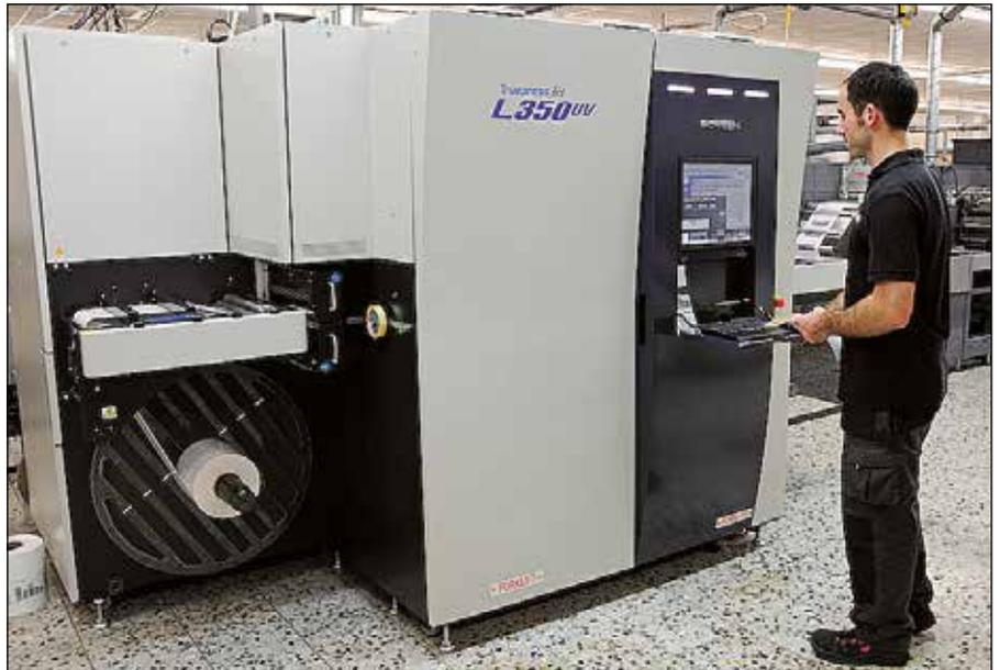
**Durch die automatische Reinigung der Druckköpfe wird bei der Screen Truepress Jet L350UV die Wartungszeit auf 15 Minuten am Tag verkürzt.**
