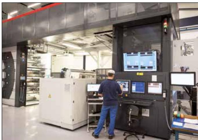
**Der Bediener an der Maschine schaut auf die Touchscreens der hoch automatisierten EVO XG von KBA-Flexotecnica.**
