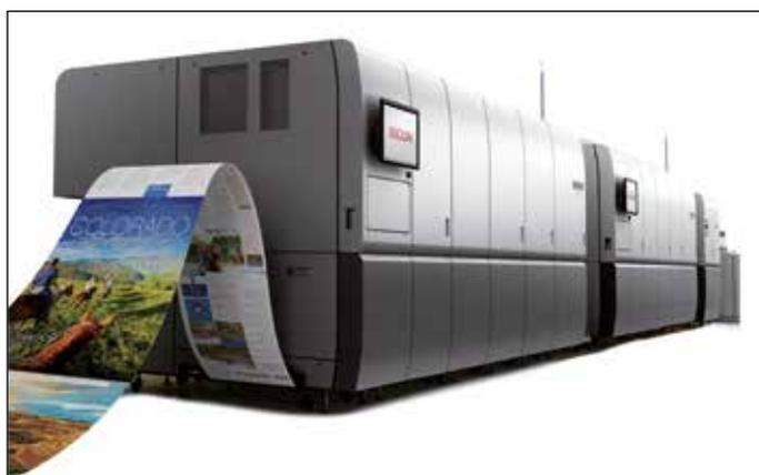
**Die Ricoh Pro VC60000 ermöglicht die Verarbeitung von Rolle-zu-Rolle und Rolle-zu-Bogen.**
