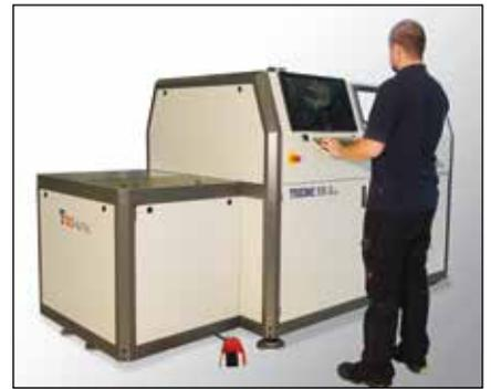
**Die Thieme 505 D verfügt über ein maximales Druckformat von 400 x 600 mm.**
