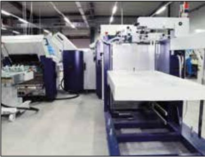
**Der Flachstapelanleger FSA kann auch Bogen mit einer Länge von bis zu 130 cm verarbeiten.**
