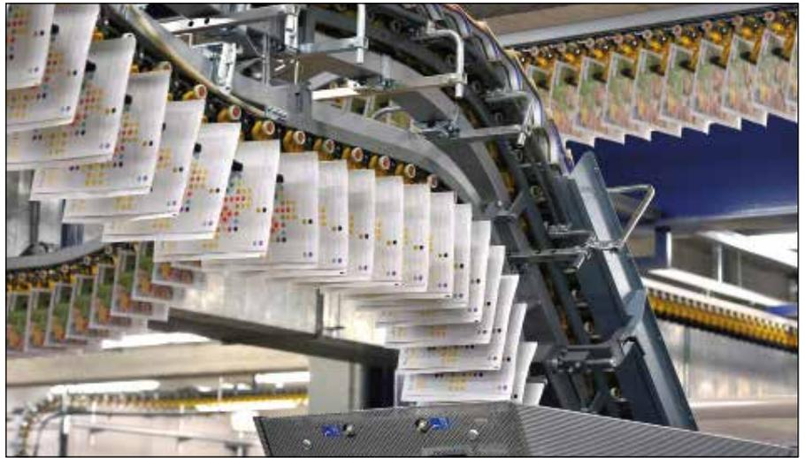
**Hardware-technisch wurde jetzt erstmals der Versandraum einer Druckerei in der Schweiz komplett mit der „Referenzklammer-Technologie“ ausgerüstet, durch die sich jedes Zeitungsexemplar mit seiner Beilagenkollektion konkret adressieren und verfolgen lässt.**
