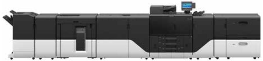
**Die TASKalfa Pro 15000c verfügt über vier Tinten-Farbstationen, druckt mit einer Auflösung von 600 x 600 dpi bzw. 600 x 1.200 dpi und einer Geschwindigkeit von 150 A4-Seiten pro Minute in Farbe oder Schwarz-Weiß mit Grammatiken von 52 bis maximal 360 g/qm ohne Geschwindigkeitsverlust.**
