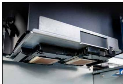
*Die Druckköpfe des WF1 sind diagonal angeordnet und sorgen für einen effizienten Druckprozess,*
