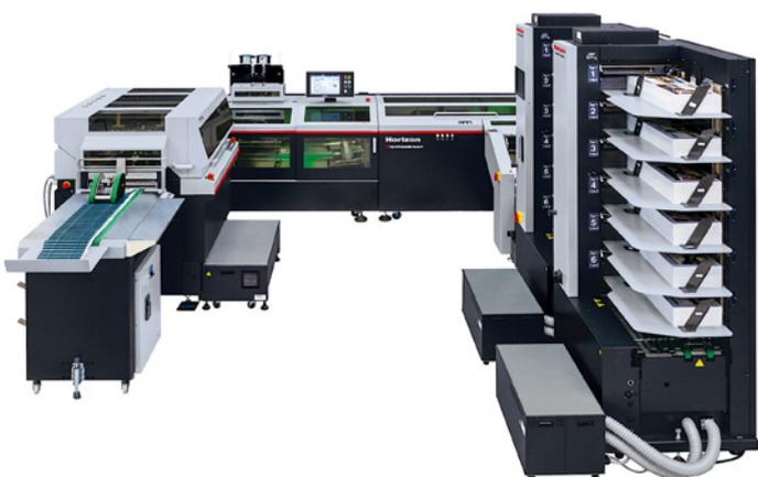
**Der iCE Stitch-Liner Mark IV vereint alle Prozesse vom Zusammentragen, Rillen, Falzen und Sammelheften bis hin zum Dreiseitenbeschnitt. Die neue Heftdrahtlängensteuerung WDD-SPF50 bietet noch mehr Flexibilität und Qualität bei variablen Umfängen.**
