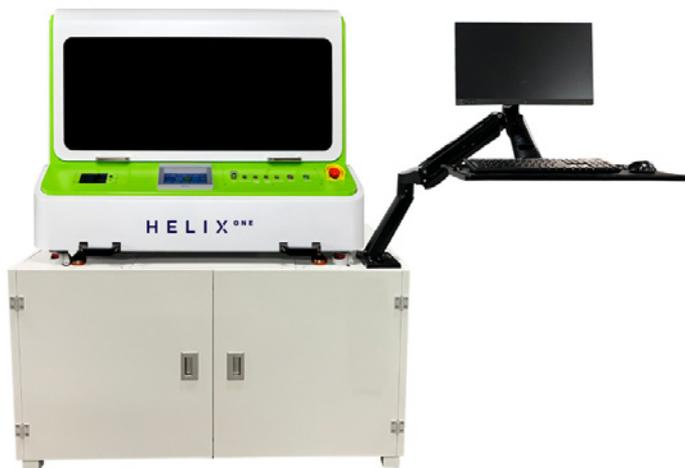
**Die Helix One ist eine spezielle Zylinderdruckmaschine, die für die Verzierung von geraden und konischen Zylindern entwickelt wurde. Sie ist mit einer 8W segmentierten, softwaregesteuerten UV-Aushärtungseinheit ausgestattet, die für eine optimale Aushärtung sorgt.**
