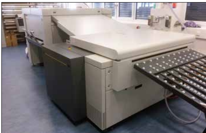
Der Kodak Magnus Q800 Plattenbebilderer im Produktionswerk Singen wurde nachträglich mit einer Einzelkassetteneinheit automatisiert.
