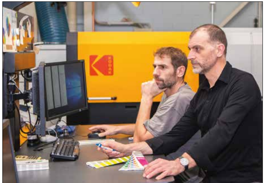
Die Bedienung und Steuerung der Nexfinity Druckmaschine erfolgt über das Kodak Digital Front End.
