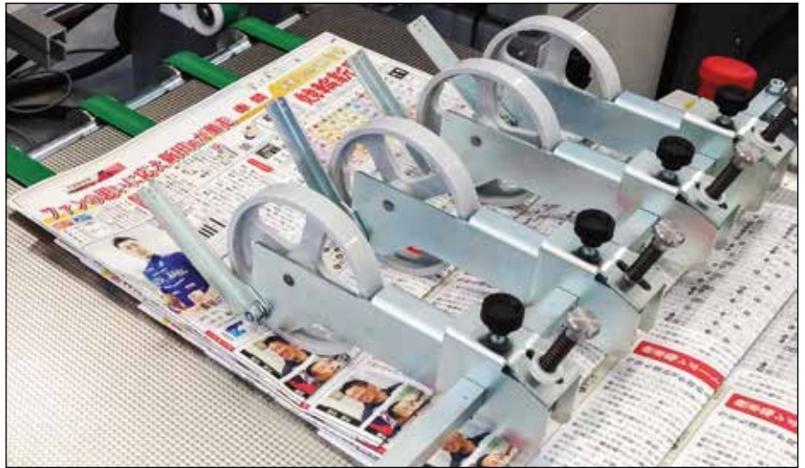
Tecna NewsReady schneidet die bedruckte Papierbahn in Bogen und sammelt diese. Anschließend werden sie gefalzt und sind dann zur Auslieferung bereit.
