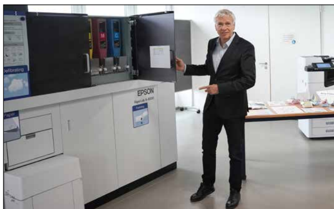
Das Epson PaperLab A-8000 setzt auf eine Kombination aus drei Prozessen, um aus Altpapier neues Papier zu machen: Zerfasern, Binden und Formen. Das recycelte Papier kann für herkömmliche Laserdrucker, Tintenstrahldrucker und Kopierer verwendet werden.
