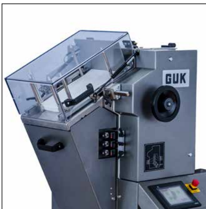
Auf kleinstem Einbaumaß kann die Cartonac 2000-Serie in jede Verpackungsmaschine integriert werden. Der Antrieb kann direkt durch die Verpackungsmaschine erfolgen.
