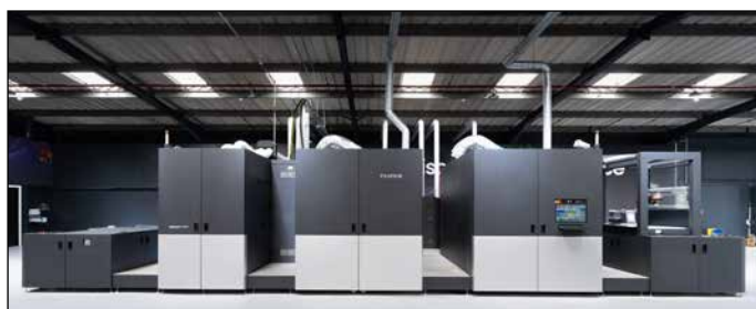
Durch Druckköpfe mit einer Auflösung von 1.200 x 1.200 dpi in Kombination mit CMYK-Tinten erreicht die Jet Press FP790 eine extrem hohe Farbdichte.
