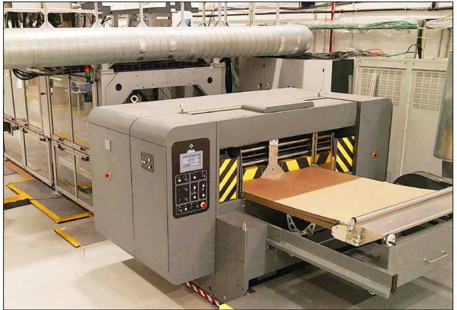
Die neue Großformat-Lösung Vulcan mit einer Bogengröße von 140 cm x 170 cm nimmt in den Highcon-Entwicklungslabor Gestalt an. Das Bild zeigt den Prototypen.
