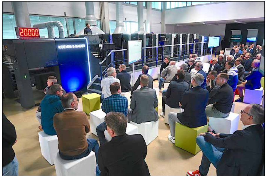
4-über-4-Druck an einer Achtefarben-Rapida 106X mit Druckleistungen von 20.000 Bogen/h.
