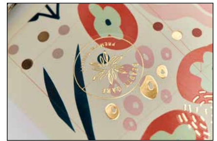
Die „3D Inkjet on Substrate“-Technologie ermöglicht eine hochpräzise Aufbringung von digitaler Metallisierung und UV-Spot- und Relieflackierung.
