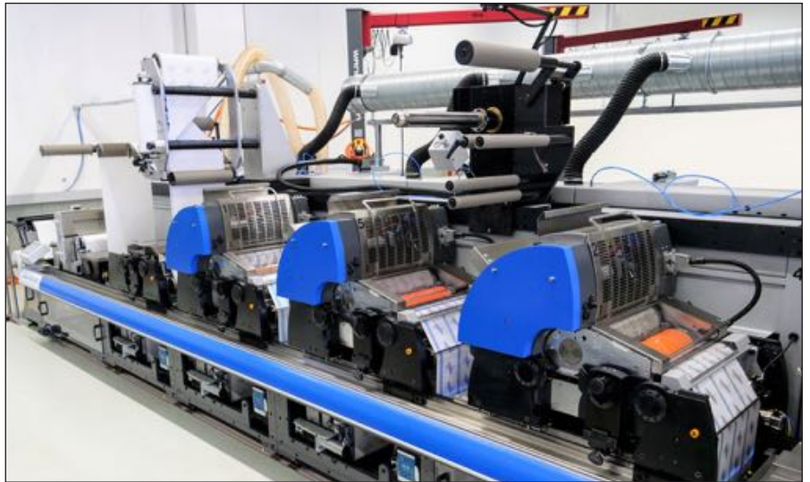
Schmalbahnmaschine ausgestattet mit UV-Offset-Druckwerken. Sie kann beliebig mit weiteren Druckwerken und Finishing-Einheiten konfiguriert werden. (Quelle: Gallus Ferd. Ruesch AG)
