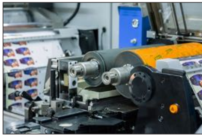
Das außerhalb der Maschine vorbereitete Flexodruckwerk wird für den Lackauftrag in der Maschine positioniert. (Quelle: Gallus Ferd. Ruesch AG)
