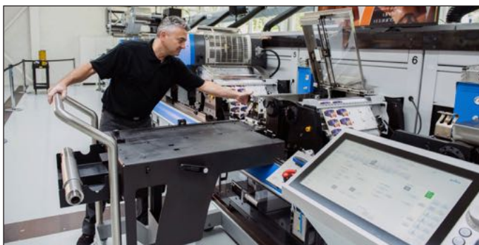
Der Austausch von Druckwerken lässt sich innerhalb weniger Minuten durchführen. (Quelle: Gallus Ferd. Ruesch AG)
