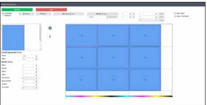
**Bogenplaner, der einen berechneten Druckbogen anzeigt und dem Bediener manuelle Eingriffe ermöglicht**
