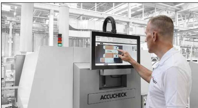
**Das in Faltschachtel-Klebe Maschinen vollständig integrierte System für die Inline-Qualitätskontrolle Accucheck kontrolliert sorgfältig jede einzelne Verpackung.**
