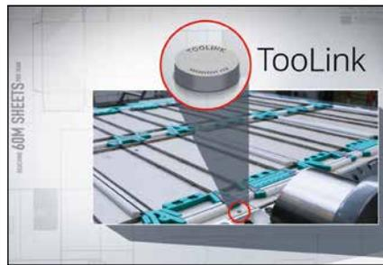
**Bei TooLink Connected Tooling werden mit Chips ausgestattete Werkzeuge und die auf ihnen gespeicherten Auftragsdaten von den Stanzen automatisch erkannt.**
