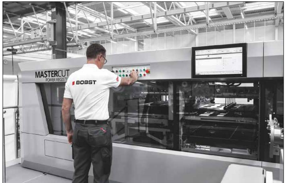
**Die neuen Automatisierungsfunktionen der Mastercut 106 PER ermöglichen um bis zu 15 Minuten verkürzte Einstellzeiten. Beispielsweise werden sowohl die Ausbrech- und Nutzentrennwerkzeuge als auch der Nonstop-Rechen in der Auslage automatisch eingestellt.**
