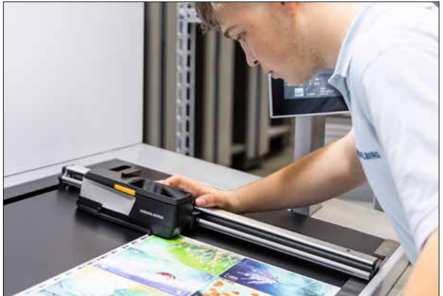
Das neue Prinect Easy Control bietet einen flexiblen Einstieg in die spektrale Farbmessstechnik.
