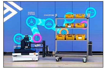
Der Flexxbot mit flexiblem Greifarm hat eine maximale Zuglast von 1.000 kg.
