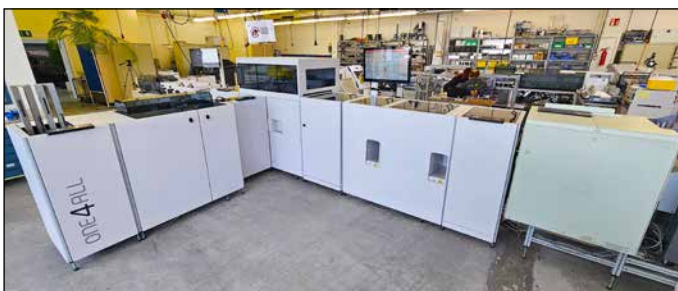
Neben einer neu entwickelten Falzeinheit verfügt die One4All über einen besonderen Clou: Ein Deltaroboter appliziert bis zu sechs Plastikkarten frei auf dem Trägerpapier.
