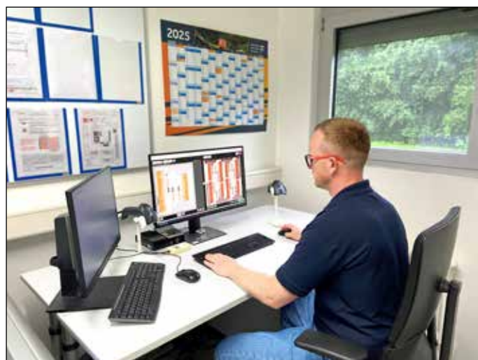
Um eine objektive, reproduzierbare Qualitätskontrolle von Texten, Farben, Grafiken und Codes zu gewährleisten, vergleicht der EyeC Proofiler 1200 DT die Druckerzeugnisse digital gegen freigegebene PDF-Vorlagen und prüft dabei sowohl Druckqualität als auch die Korrektheit des Inhalts.
