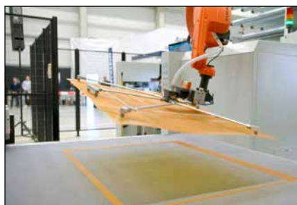
Allstein-Robotik übergibt die zugeschnittenen Platten an die automatisierte Montage. (Quelle Allstein)
