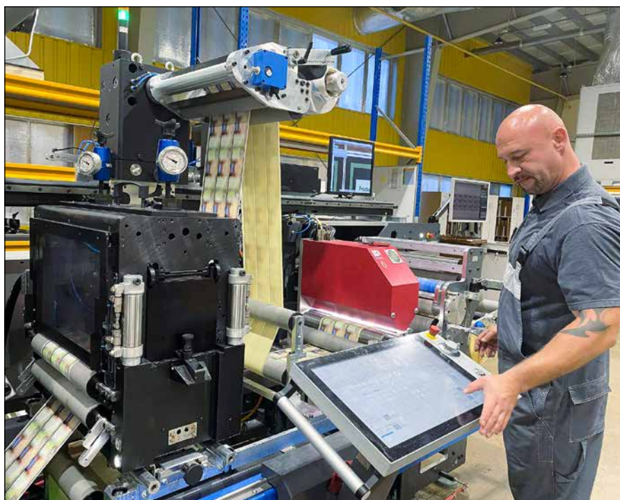
Von der manuellen Kontrolle zur Null-Fehler-Produktion: Bei A-Z Color bleibt durch das scannerbasierte Offline-Inspektionssystem EyeC Proofifier 1200 DT zur Druckmusterkontrolle sowie das Inline-System EyeC ProofRunner Web zur 100-prozentigen Prüfung jedes gedruckten Etiketts keine Abweichung unentdeckt.
