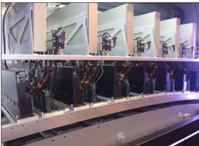
Druckkopfreihe CMYK mit Orange und Violett (Quelle: pack. consult)
