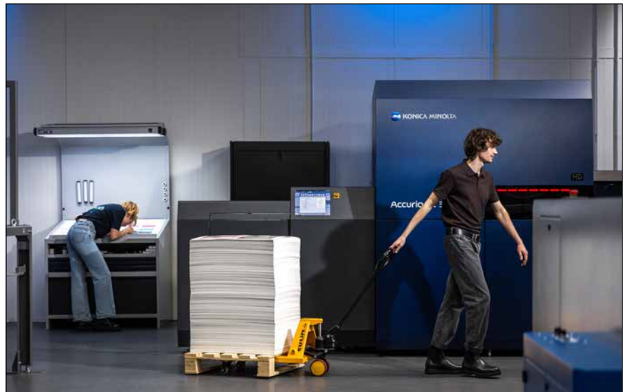
Die AccurioJet 30000 ermöglicht das Bedrucken einer breiten Palette von Substraten, bis hin zu Leinwandsubstraten, kunststoffbasierten Medien oder vormetallisierten Materialien.
