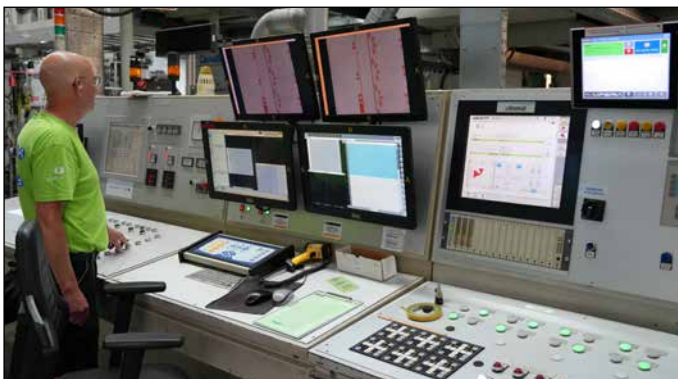
Lückenlose Qualitätskontrolle im Drucksaal. Das Inspektionssystem erkennt jeden Fehler, wie beispielsweise Einschlüsse im Papier oder Staub auf der Bobine.
