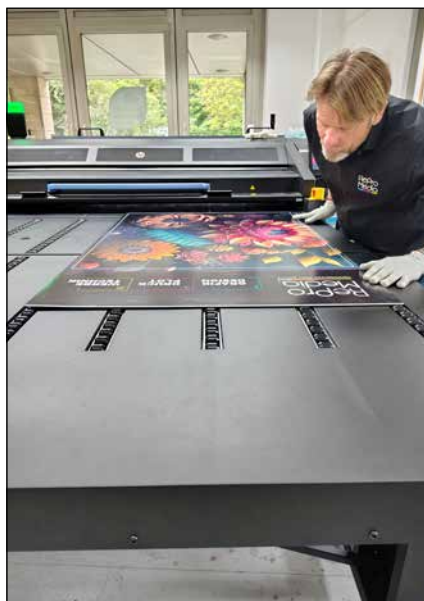
Der HP Latex R530 erreicht Geschwindigkeiten von bis zu 24 qm/h im Indoor-Modus ...
