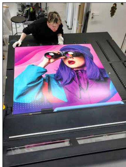
... und verarbeitet Platten mit einer Breite von bis zu 1,6 m und einer Stärke von bis zu 5 cm.
