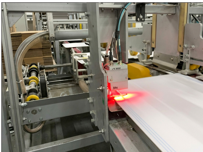
CorrBox Solution evo in Action, hier bei einem Testlauf mit blau eingefärbtem Klebstoff
