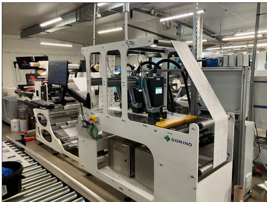
Der digitale K300 Inkjetdrucker wurde entwickelt, um eine hohe Druckqualität bei hoher Geschwindigkeit zu liefern, wodurch er sich ideal für den Druck variabler Daten und die Personalisierung im späten Produktionsstadium eignet.
