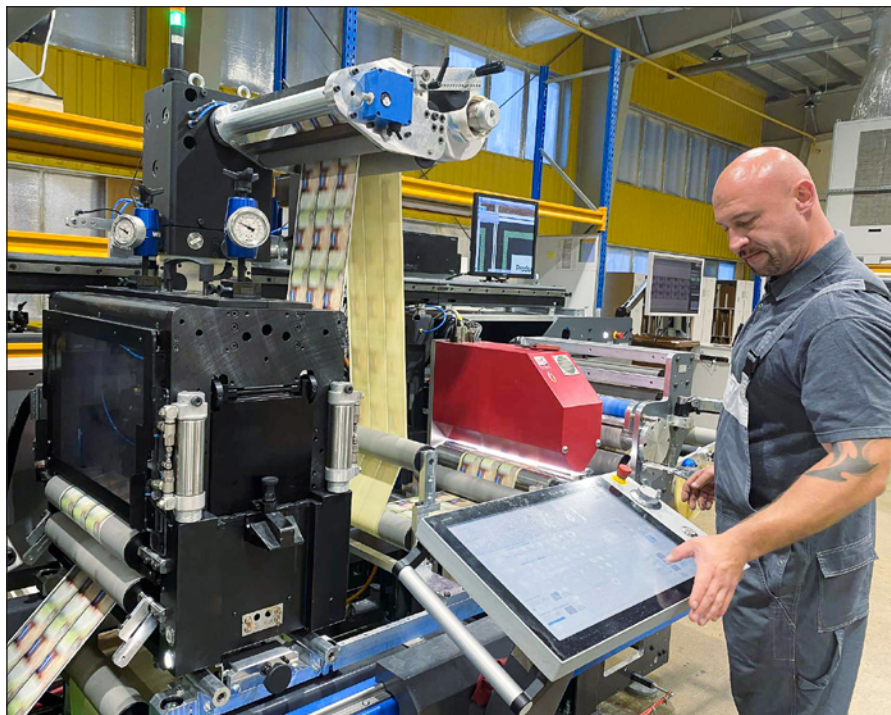
Von der manuellen Kontrolle zur Null-Fehler-Produktion: Bei A-Z Color bleibt durch das scannerbasierte Offline-Inspektionssystem EyeC Proofiler 1200 DT zur Druckmusterkontrolle sowie das Inline-System EyeC ProofRunner Web zur 100-prozentigen Prüfung jedes gedruckten Etiketts keine Abweichung unentdeckt.
