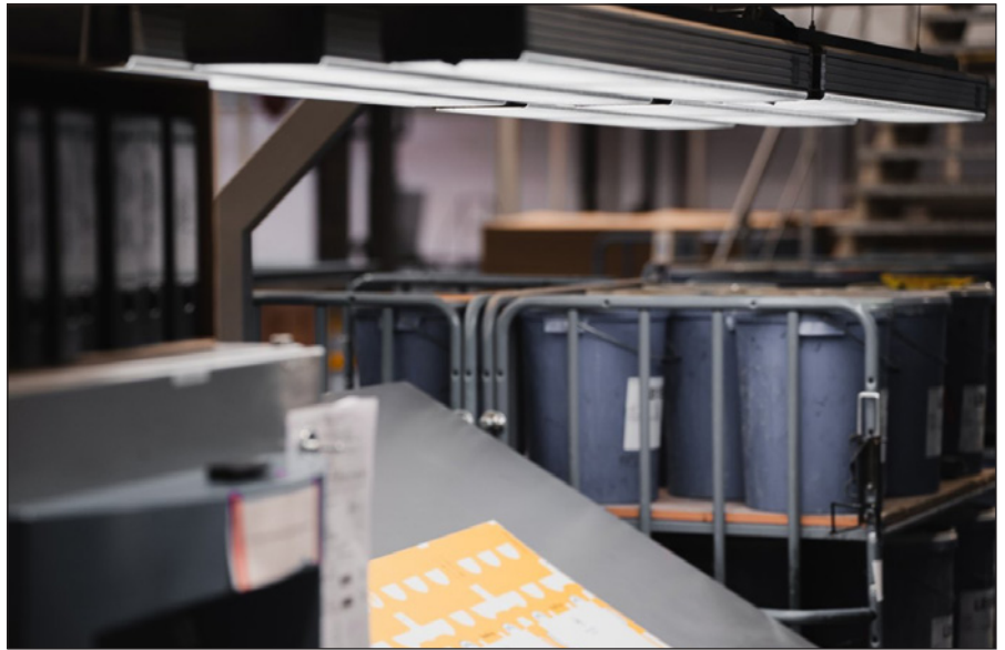
Die JUST-Normlichtsysteme sorgen für standardisierte reproduzierbare Lichtbedingungen.
