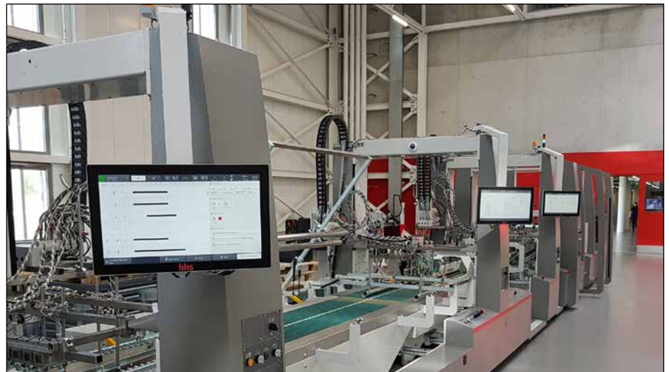
Im Competence Center von Bobst in Mex in der Schweiz sind insgesamt sechs Faltschachtel-Klebmaschinen mit Technik für Leimauftrag und Qualitätskontrolle von Baumer hhs ausgestattet.
