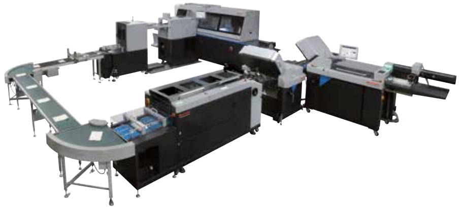
Vollautomatische Bindestraße: BQ-480 mit der variablen Falzmaschine AFV566, dem Buchblock-Stacker BBS-40 und dem Buchblock-Feeder BBF-480.
